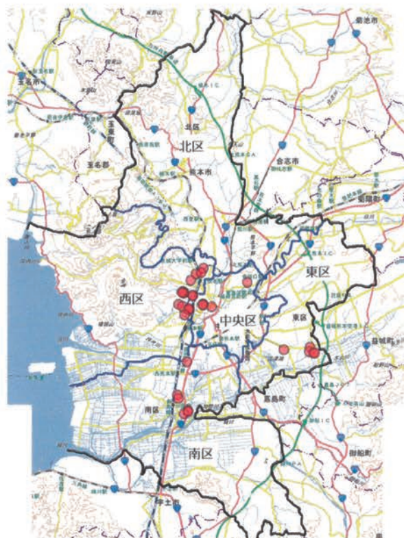
図4 CIPの被害地点
