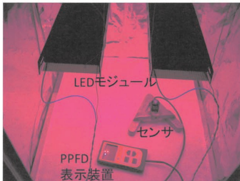
図3 実験用栽培床でのLEDモジュール下のPPFD計測
