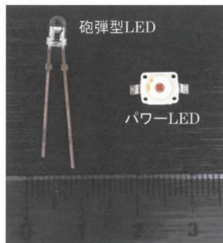
図4 砲弾型LEDとパワーLED
