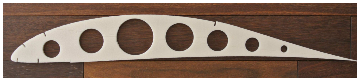
図8 レーザーカッターにより切り出したリブの例
