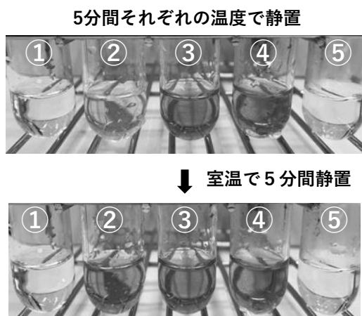
図6 酵素反応の温度依存性および高温での酵素失活
