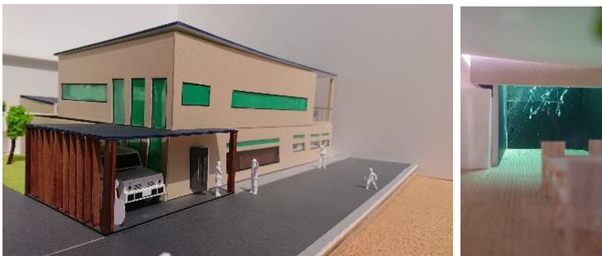
図 8 住宅建築と一体化する「光合成パネル」の水平窓と天窓から降り注ぐグリーン光
