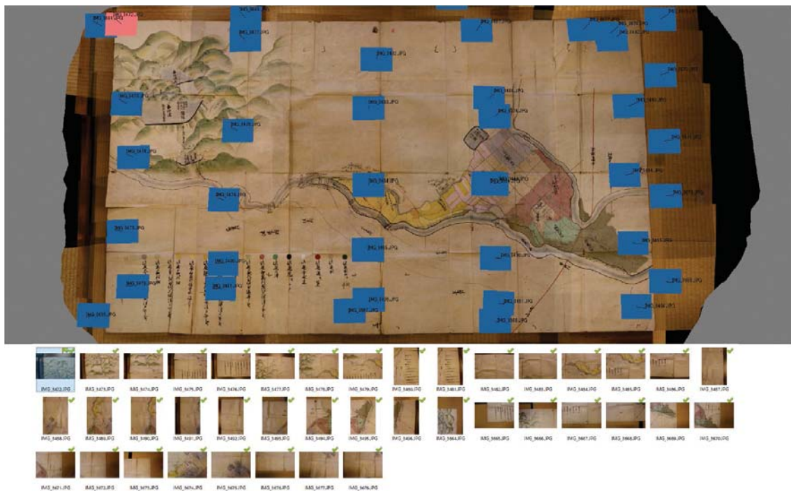
図 2 元の 40 枚の写真（下段）と計算されたカメラの位置・姿勢
