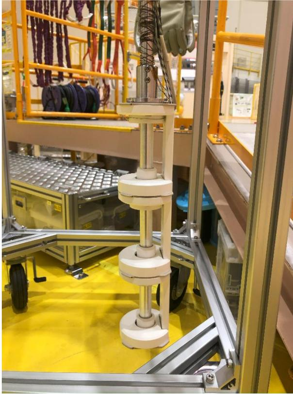
図 19. 位置検知型自動試料昇降機 (PEACE).
