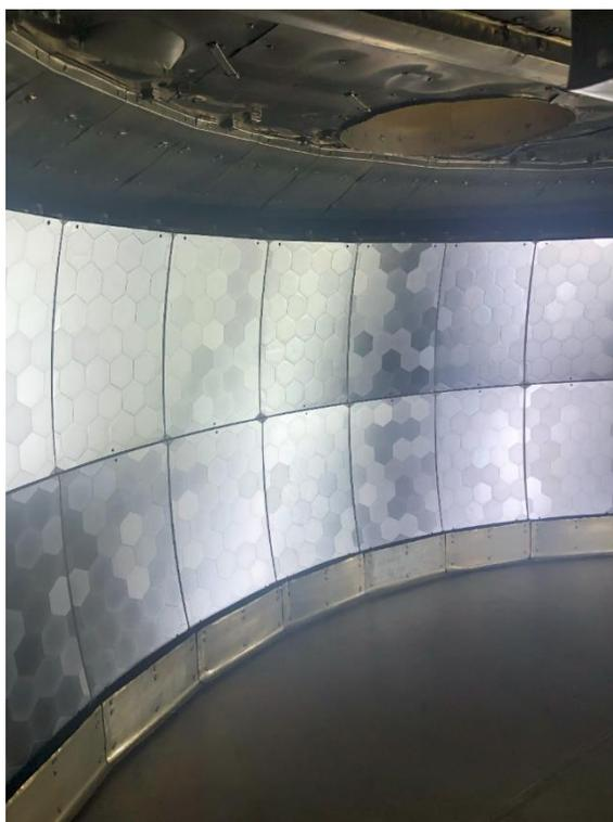
図 11. DNA に設置されている Si 結晶アナライザーミラー。
