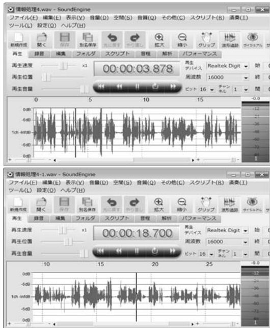
図8：サンプルデータを用いた音声波形の取得結果、(上) やや強調して読み上げた場合、(下) 会話レベルで読み上げた場合
