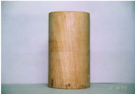
写真 3.2.16 大斗下ダボの状況(東側面) 水平載荷実験終了後 12/18 の状況
