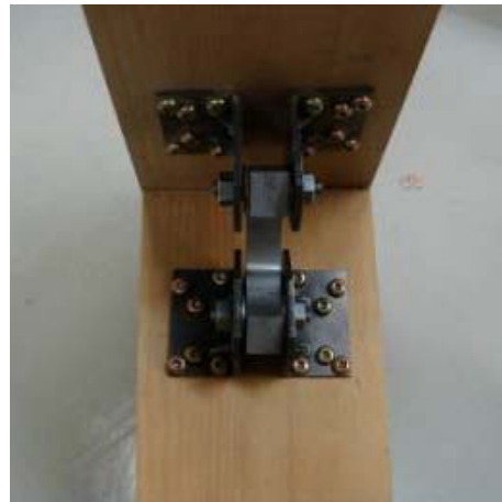
(b)超塑性合金材料を用いた仕口ダンパー
