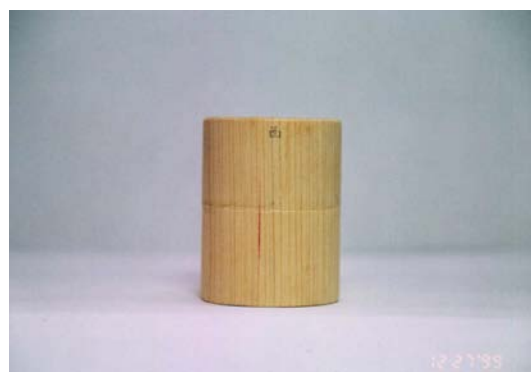
写真 3.2.39 西側巻斗下ダボの状況(西側面) 全実験終了後 12/27 の状況
