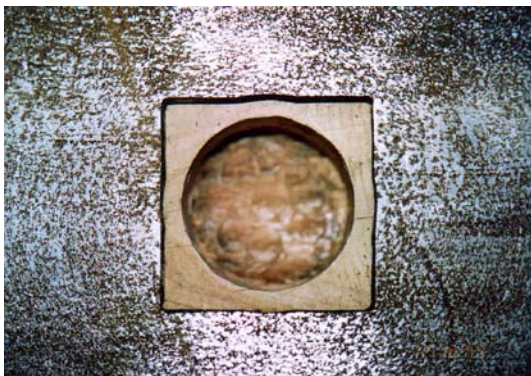
写真 3.2.18 台盤内木材のダボ穴 水平載荷実験終了後 12/18 の状況
