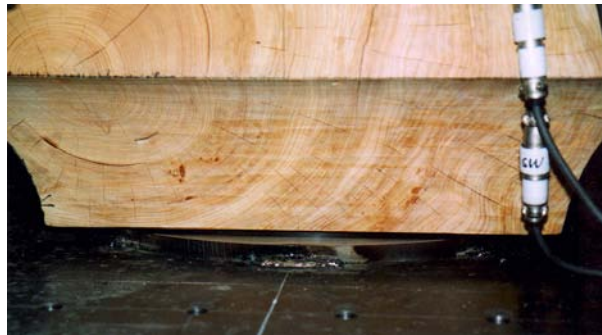
写真 3.2.11 大斗尻の浮上り(東面) N=17ト(167kN) R=+20/1000
