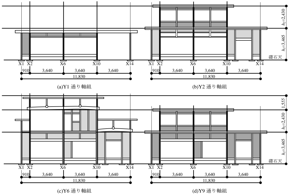
図 9.4.3 桁行方向軸組 1/200 外壁 内壁
