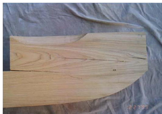
写真 3.2.29 梓肘木のひび割れ (南面・東側) 全実験終了後 12/27 の状況
