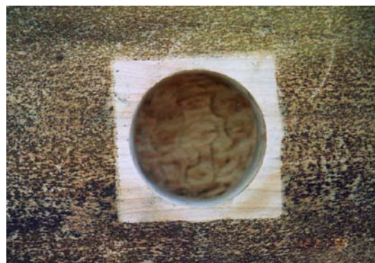
写真 3.2.25 大斗底面のダボ穴 (上が南側・右が東側) 全実験終了後 12/27 の状況
