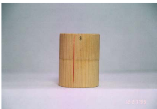
写真 3.2.38 西側巻斗下ダボの状況(東側面) 全実験終了後 12/27 の状況
