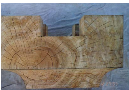
写真 3.2.28 大斗側面のひび割れ (東側面) 全実験終了後 12/27 の状況
