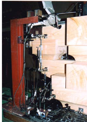
台盤からの絶対変位を測定する
