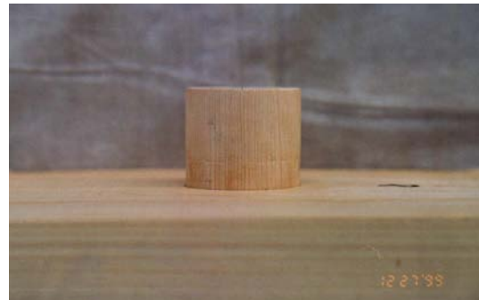
写真 3.2.35 方斗下ダボの状況(西側面) 全実験終了後 12/27 の状況
