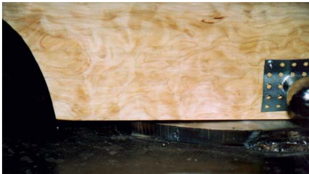
写真 3.2.9 大斗尻の浮上り(北面・東側) N=26ト(255kN) R=+20/1000
