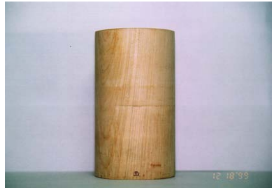
写真 3.2.17 大斗下ダボの状況(西側面) 水平載荷実験終了後 12/18 の状況
