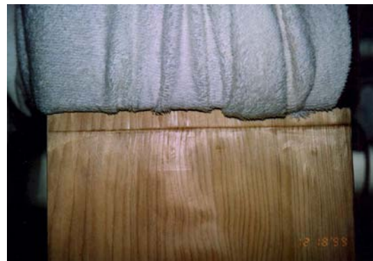
写真 3.2.19 杵肘木下面大斗東側接触部 水平載荷実験終了後 12/18 の状況
