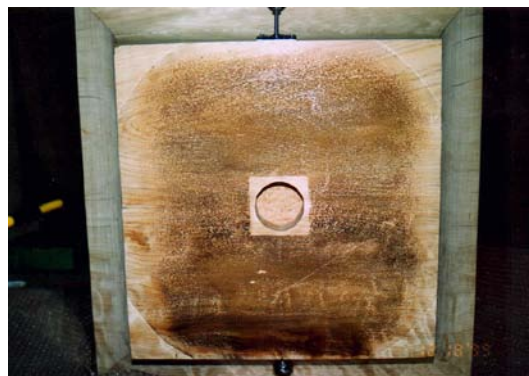
写真 3.2.15 大斗底面の状況(上が南側・右が東側) 水平載荷実験終了後 12/18 の状況
