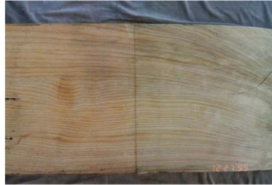
写真 3.2.31 枳肘木下面大斗東側接触部 全実験終了後 12/27 の状況
