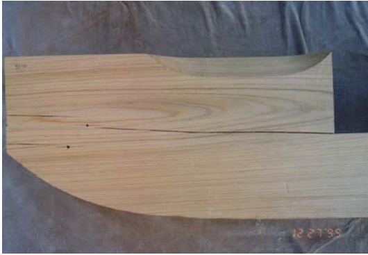
写真 3.2.30 枳肘木のひび割れ (南面・西側) 全実験終了後 12/27 の状況
