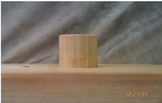
写真 3.2.34 方斗下ダボの状況(東側面) 全実験終了後 12/27 の状況
