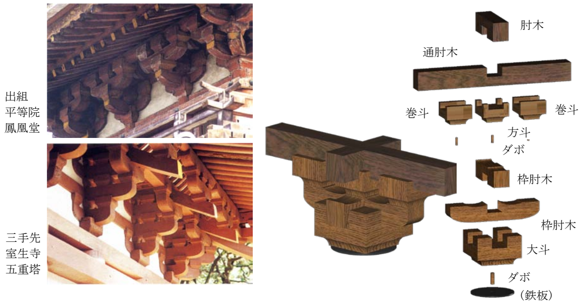
図 3.1.2 伝統木造建築の組物とその構成
